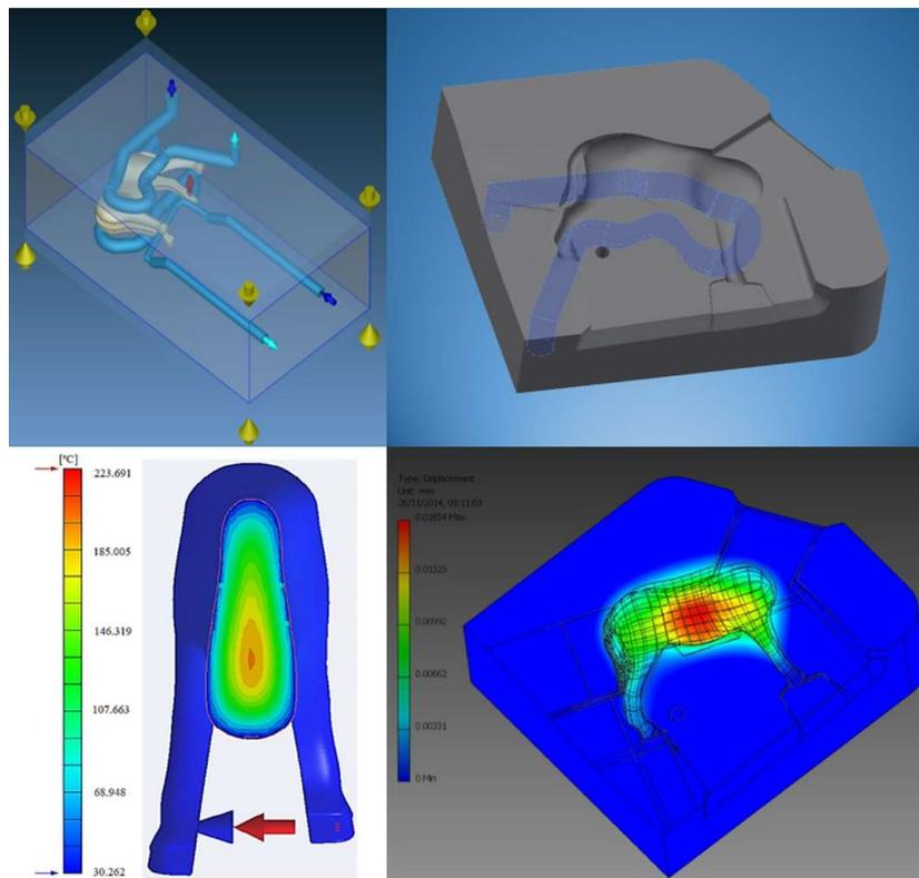
L'utilizzo di sistemi additivi 3D di sinterizzazione, ha permesso di creare canali di raffreddamento ad elevata complessità e prestazioni.
